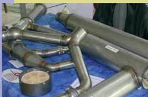
Mesures 6 et 7 : modèles de silencieux d'échappement permettant de réduire le bruit à la source.
