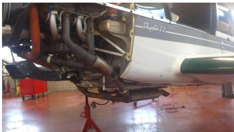
*Figure 5: Installation d'un silencieux sur un DR 400 – hangar Aéraudit*
